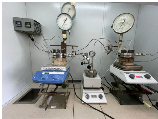
Рис. 1. Автоклавная установка для реакции гидроалкоксихарбонилирования олефинов
