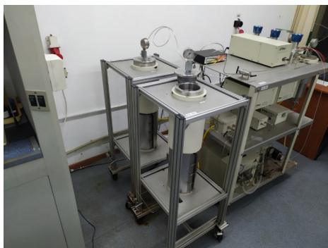
Рис.1 - Установка для сверхкритической флюидной экстракции Thar 1000
