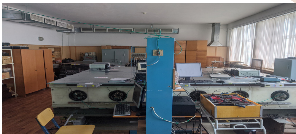
Рисунок 2 – Нейтронный супермонитор 6NM-64
