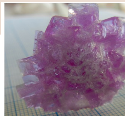
Рис. 1. Кристалл K_7CaNd_2(B_5O_{10})_3 , выращенный из флюса K_2O-B_2O_3-CaF_2 .
